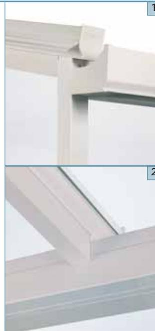
*FINSTRAL-Überdachungen bestehen aus einem verzinkten Stahlgerippe. Die Stahlprofile werden mit Hart-PVC-Profilen ummantelt und das Dach außenseitig mit pulverbeschichteten Aluminium-Schalen verblendet. Diese Kombination garantiert eine stabile, wetterfeste und langlebige Konstruktion.*
