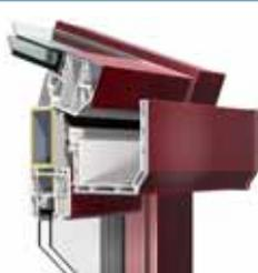
Die Dachrinne mit ästhetischer Profilierung und großem Fassungsvermögen passt sich dem Wintergarten harmonisch an und rundet den Gesamteindruck optisch ab. Außenliegende Glaskanten werden mit einem Mehrkammernprofil gedämmt. Somit wird Kondenswasserbildung weitgehend vermieden.
