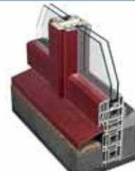
Wärmedämmende und winterfeste Bodenanschlüsse durch Mehrkammernprofil. Eine Fuge zwischen Elementrahmen und Anschlussprofil erleichtert die Montage der Schutzfolie (Feuchtigkeitsschutz) und des Anschlussbleches.
